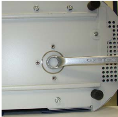
Fig. 48: Fechamento do depósito de fluidos
